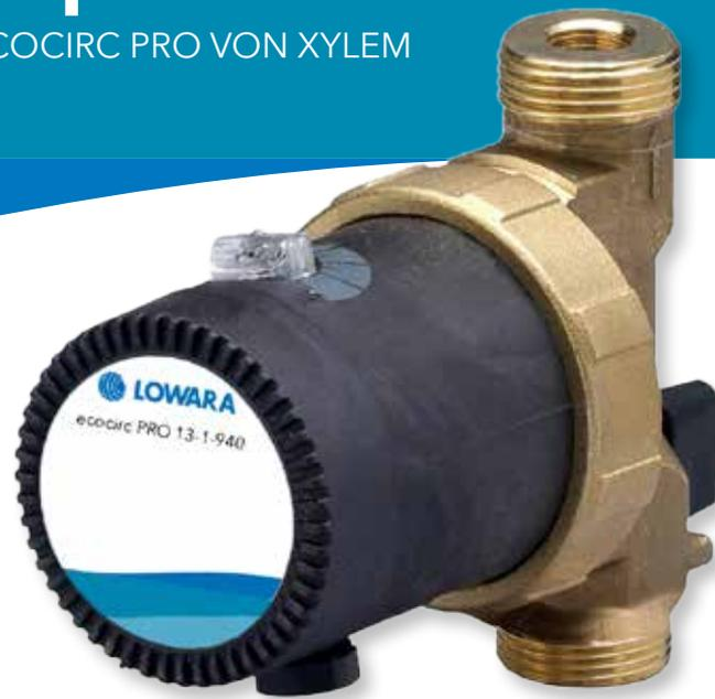
Das neue Gehäuse der Trinkwasser-Zirkulationspumpe Lowara ecocirc PRO 13-1/940 verfügt über ein 3/4" Außengewinde. Damit können Sie Ihre Rohr- oder Pressverschraubung direkt, schnell und einfach mit dem Pumpengehäuse verbinden.
